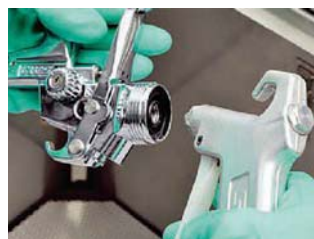
Fig. 07 O meio de secagem mais adequado para secar pistolas de pintura é a pistola de ar comprimido. O ar deve ser bem filtrado e sem humidade e a pressão de secagem não deve ser máxima.
