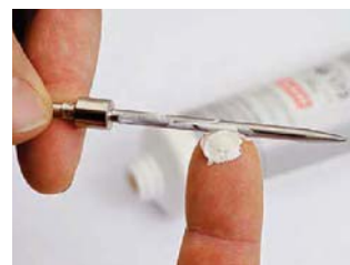
Fig. 08 Aqui vemos aplicar a massa lubrificante especial numa agulha de uma pistola SATA. A correta lubrificação das pistolas prolonga a sua vida útil e mantém o seu rendimento e performances originais.
