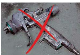
Fig. 05 Evitar mergulhar evitar as pistolas em diluente, pois isso danifica os componentes electrónicos das pistolas digitais.
