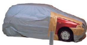
Cobertura de viaturas para pintura
